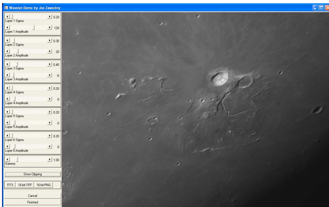
Figura 23: La ventana de procesamiento por ondículas. A la izquierda aparecen hasta seis capas posibles, en las que ajustar el valor de Sigma (escala de resolución del detalle) y de la amplitud (grado de intensidad con que se aplica Sigma).
