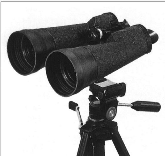
*Cuando el diámetro del objetivo y los aumentos son elevados, es preciso apoyar el instrumento en un soporte fijo, para evitar las vibraciones. Un trípode corriente será un buen auxiliar para el observador de cometas, novae y estrellas variables*
