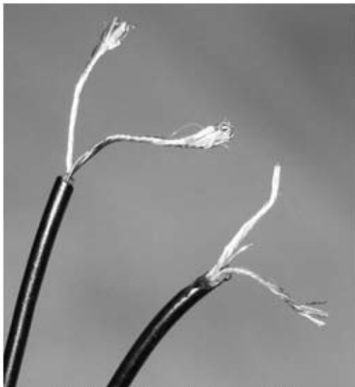
Figura 3 – Cables de auriculares cortados
