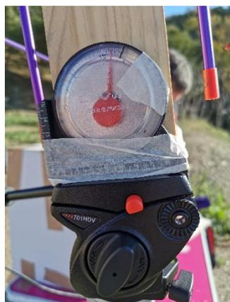
Inclinómetro para controlar la altura de la antena.
