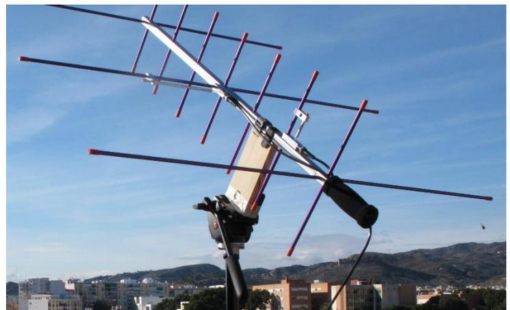
Foto 3.1. Antena Arrow 146 – 437 – 10WBP montada en el lugar de observación.
