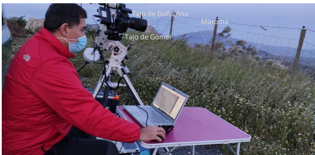
Aquí estoy sincronizando la imagen en el ordenador, del campo de visión del telescopio Evoguide ED50 con el de la cámara NIKON D 850, para que tengan el mismo centrado. Foto: Remedios Trujillo.
